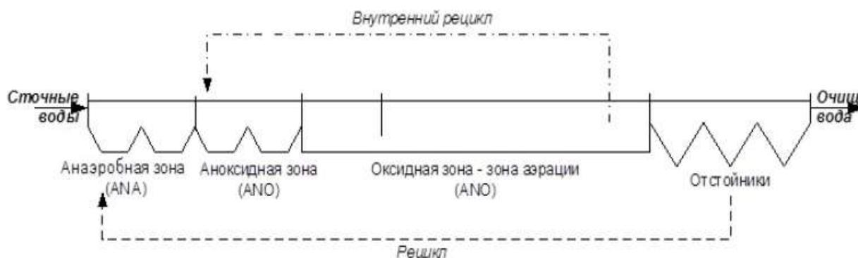
Подобная технологическая схема обеспечивает хорошие результаты по биологической очистке сточных вод, в том числе от соединений азота и фосфора.
